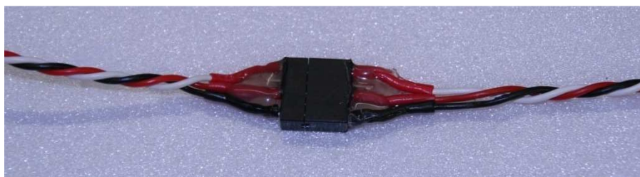
Abbildung 23: Stecker für das Querruder bei dreiteiliger Tragfläche
